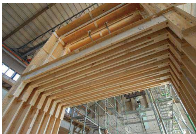
2層実大実験試験体
